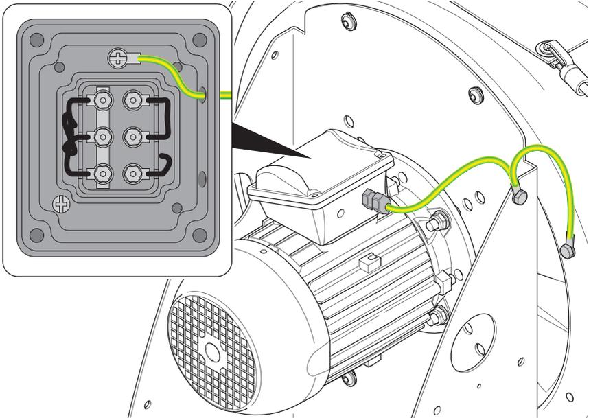
Fig. 34: Grounding cable on fan
