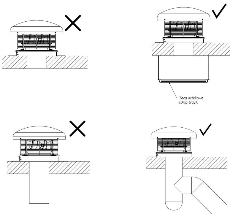
• Konstrukcja podtrzymująca urządzenie musi być w stanie utrzymać je podczas pracy z pełną mocą (należy również uwzględnić przeciążenia wywołane przez rozruch, awarię, niewłaściwe użytkowanie urządzenia). Do instalacji należy użyć elementów złącznych zabezpieczonych przed samoczynnym poluzowaniem się.
