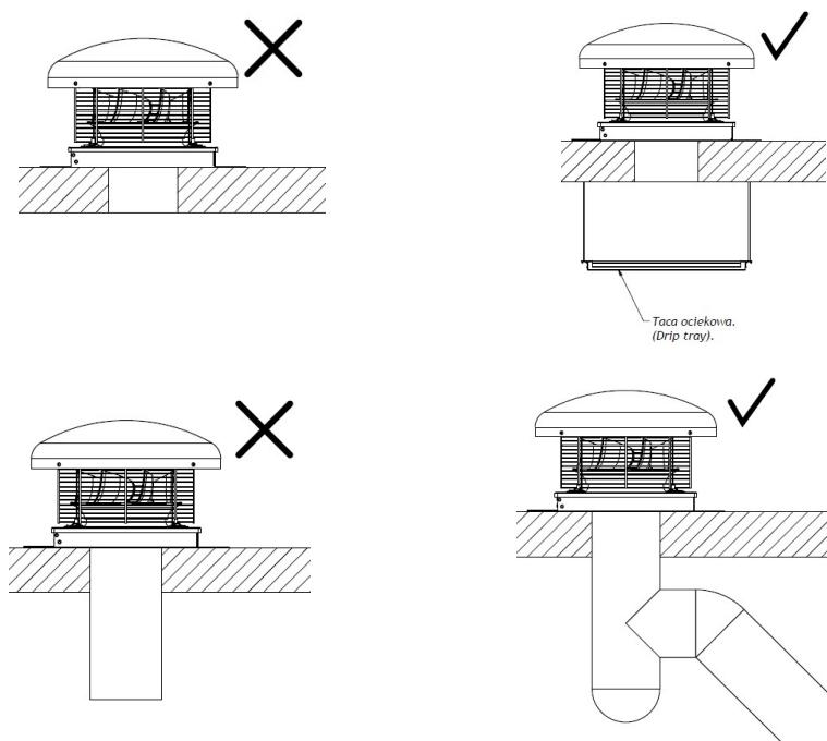
• Die Stützkonstruktion des Gerätes muss entsprechend beständig sein, um den Dachventilator während des Betriebs bei voller Leistung (es sind dabei auch die durch den Anlauf, Störung, falsche Nutzung hervorgerufenen Überlastungen zu berücksichtigen) halten zu können. Es sind bei der Aufstellung lockeresicher Verbindungselemente zu verwenden.
